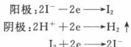
产生的碘又与试油中的水分反应生成氢碘酸,直至全部水分反应完毕为止,反应终点用一对铂电极所组成的检测单元指示。在整个过程中,二氧化硫有所消耗,其消耗量与水的摩尔数相等。
