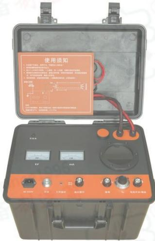
高压电桥故障测试仪是基于 MURRAY 电桥原理而设计，适用于敷设后各种电线电缆的击穿点及没有击穿但绝缘电阻值偏低的缺陷点的定位，及高压电缆外护套故障的定位。当然，也可用于电缆厂内各种线缆的缺陷点定位。
