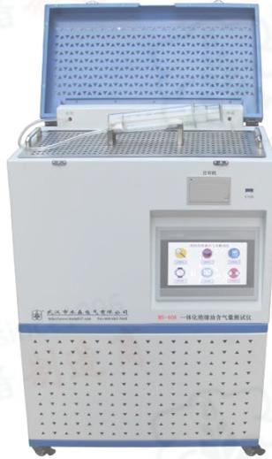
对电压等级 330-750kV 的变压器，按照规程时间静止后取样测量油中的含气量（体积分数）其值。
