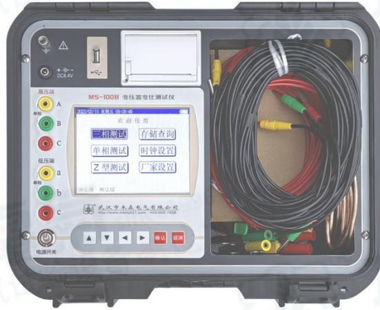
在电力变压器的半成品、成品生产过程中，新安装的变压器投入运行之前以及根据国家电力部的预防性试验规程中，要求变压器进行匝数比或电压比测试。传统的变比电桥操作繁琐，读数不直观，且要进行必要的换算，测试时只能单相进行，工作效率低。克服了传统变比电桥测试的缺点。屏幕采用了大屏幕彩色液晶显示屏，中文菜单提示，操作简便直观，一次完成三相变比测试，测试速度快、准确度高、保护功能完善。系列仪器提供了两种电源方式：外部AC220V和内部电池，方便用户进行测试。
