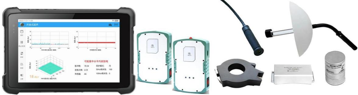
MSJF-3002B 五合一局部放电检测仪（无线 WIFI 版），可用于运行中的高压开关柜、环网柜、电压/电流互感器、变压器（包括干式变压器）、GIS、架空线路、电缆等设备的绝缘状态检测与评估。它集成了超声波、地电波、接触式超声波、特高频及高频互感器五种常用传感器。可通过指令实现各传感器的灵活切换。
