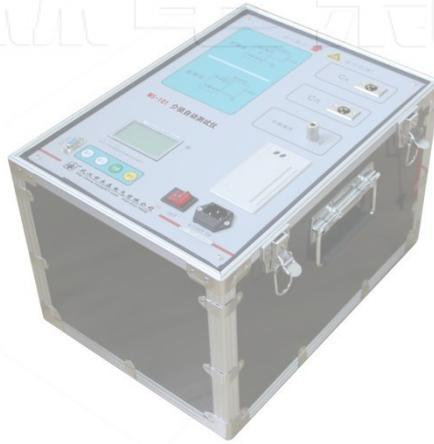
介损绝缘试验可以有效地发现电器设备绝缘的整体受潮劣化变质，以及局部缺陷等，在电工制造、电气设备安装、交接和预防性试验中都广泛应用。
